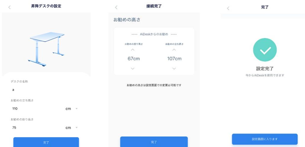
接続する電動昇降テーブルの名称、使用者の体重、身長個人データを入力します。自動でお勧めの座り高さ、お勧めの立ち高さが表示されますが、後からも変更は可能です。設定完了後、コントロール画面へ移行します。
